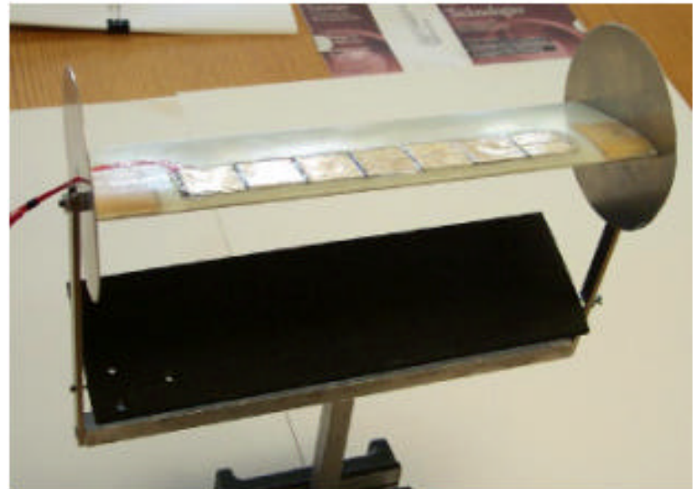
2D-Flügel mit NACA 0012 Profil und integrierten piezoelektrischen Aktuatorelementen.
